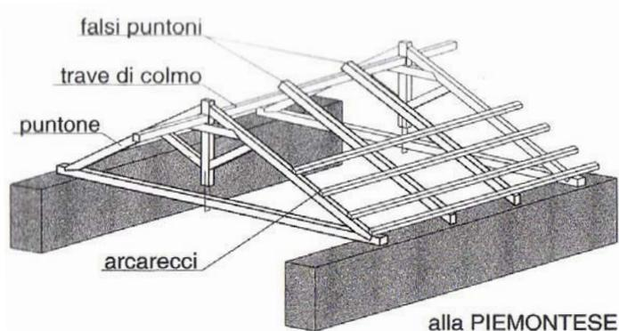
poggianti nella parte inferiore su un dormiente, ovvero su una trave fissata ai muri perimetrali. Su questa struttura principale, è possibile trovare una orditura secondaria costituita da listelli orizzontali paralleli alle linee di gronda detti arcarecci o correntini. Su questa struttura vengono appoggiati i coppi, utilizzati maggiormente nelle zone a quote minori, o le lose, lastre di pietra naturale spesso utilizzate nei fabbricati montani.
